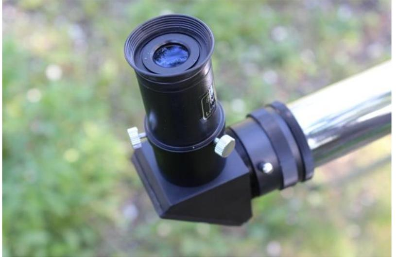
Линзы объектива и окуляров телескопа просветлены с применением фторида магния.
